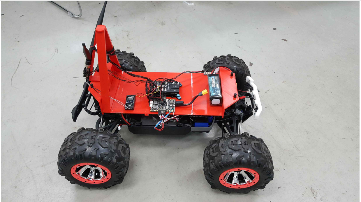
그림 7. FCC와 센서 모듈 등이 통합된 4륜 구동 주행 로봇 예시
